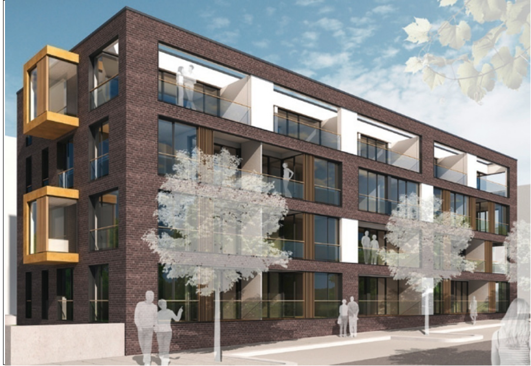
Abb. 5 : Loggien, die insbesondere gegen seitlich einfallenden Schall wirken.
