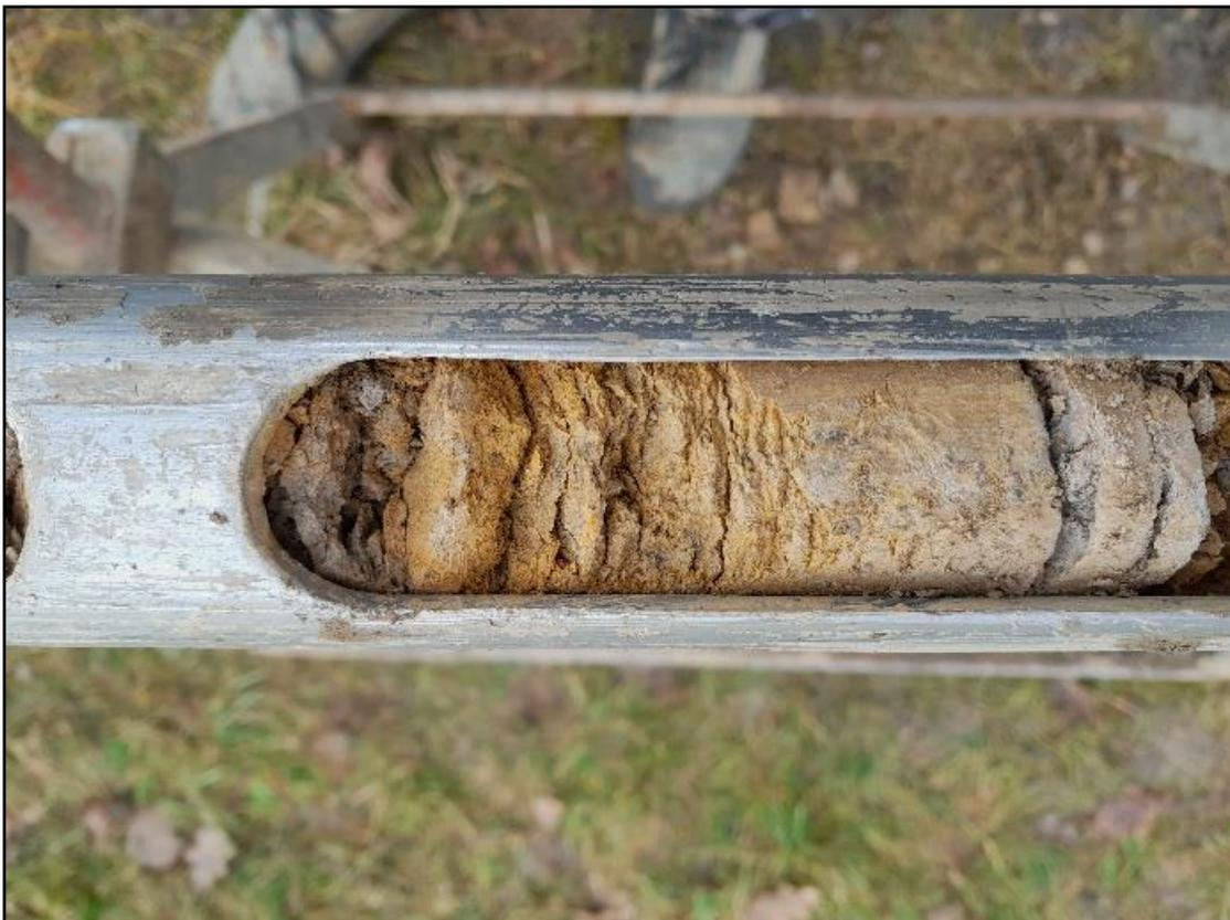
**Abb. 4:** Örtlicher Hanglemm aus dem Bereich von RKS 5 (Bodenprobe 5/1)
