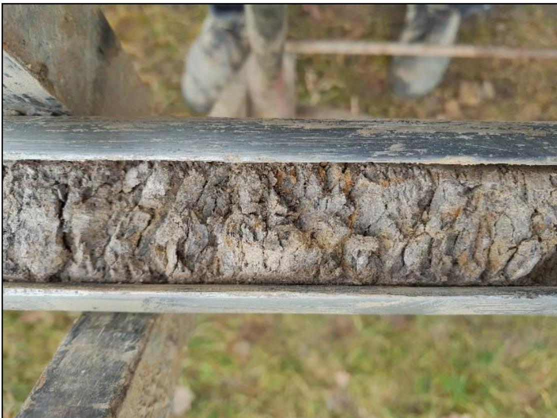
**Abb. 5:** Örtlicher Felsersatz aus dem Bereich von RKS 5 (Bodenprobe 5/2)
