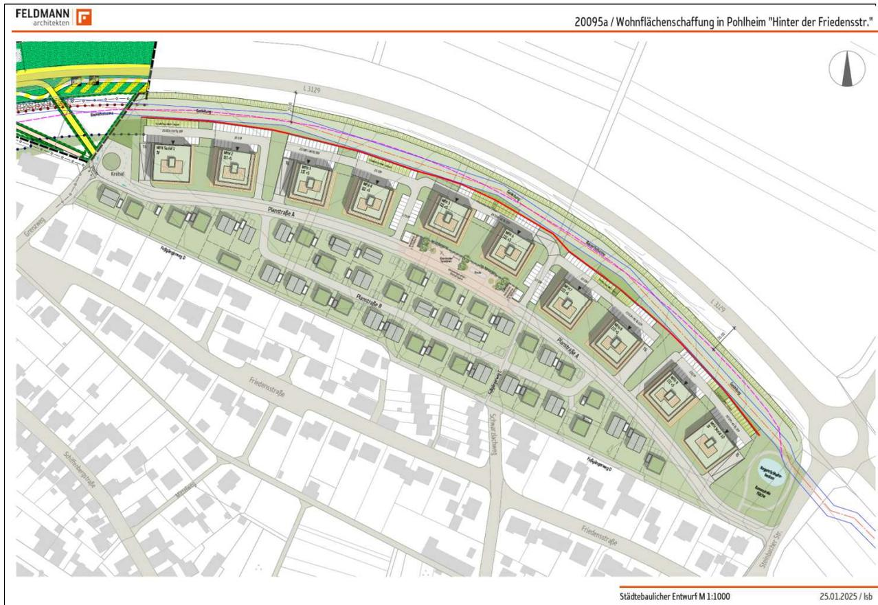
Abb. 2 : Freiflächenplan/städtebaulicher Entwurf (rot: geplante Schallschutzwand).
