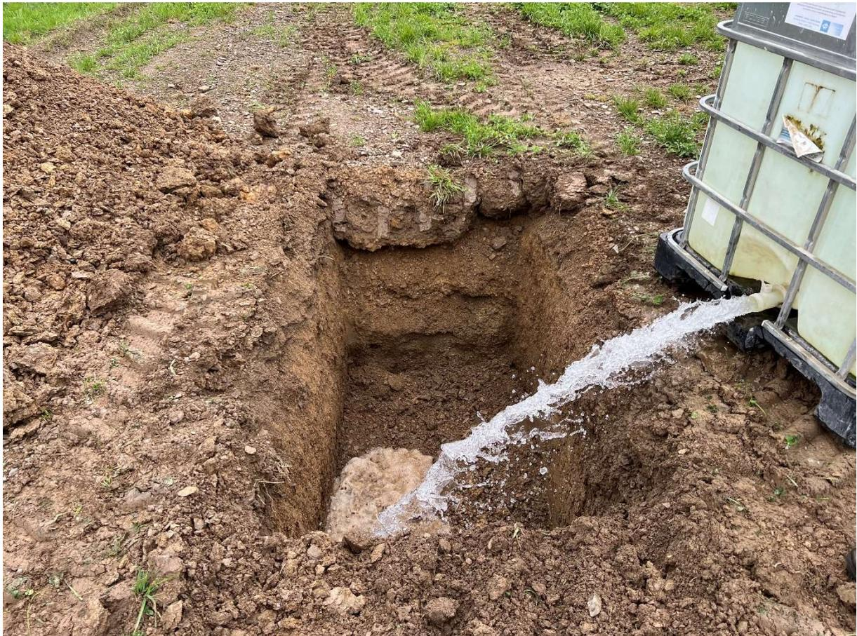
Bild 10: Untersuchungsstelle V2, gefüllte Grube, Beginn Vorwässerung
