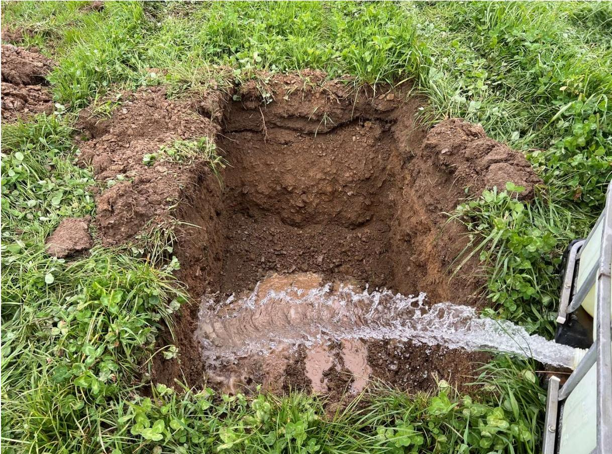
Bild 4: Untersuchungsstelle V1, gefüllte Grube, Beginn Vorwässerung
