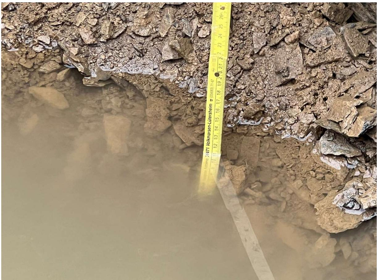
Bild 25: Untersuchungsstelle V4, vorzeitiges Versuchsende (Wasser vollständig versickert)
