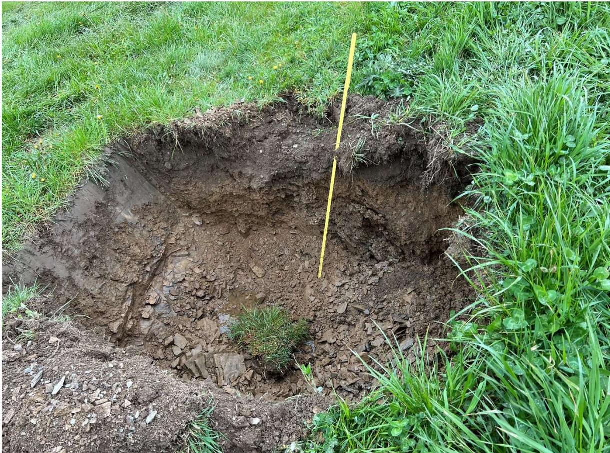
Bild 26: Untersuchungsstelle V4, vorzeitiges Versuchsende (Wasser vollständig versickert)
